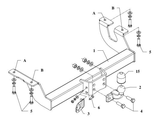
Die Anhängekupplung (Katalognummer **K14**) ist für folgende Fahrzeugtypen zugelassen: **VOLKSWAGEN LT 28, (Kastenwagen),** ab Bj. 04.2004 bis 05.2005, dient zum ziehen der Anhänger mit der Gesamtlast von **2500 kg** und der Kugelstützlast von max.**75 kg**.
