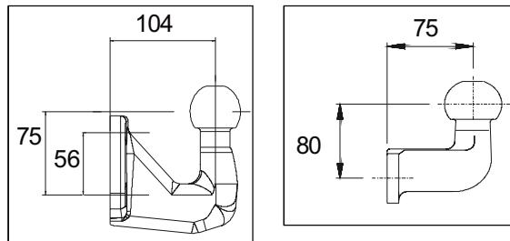
**N** Ved anvendelse av tilhengerfestet med kuledel med 2 hull skal det monteres en 75 mm lang, 80 mm høy kuledel godkjent av EC, som har en minimum D-verdi nevnt på side 1.
